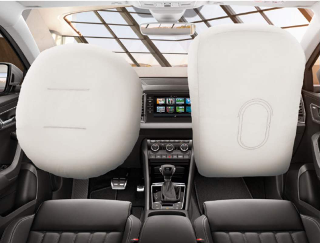
PREDNJI VAZDUŠNI JASTUCI Dok je vozačev vazdušni jastuk ugrađen u volan, suvozačev vazdušni jastuk je smešten u instrument tabli. Ako je potrebno, moguće ga je deaktivirati kada se na suvozačevo mesto smesti sedište za decu.
