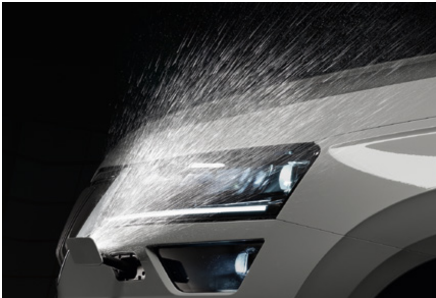
UREĐAJ ZA PRANJE PREDNIJH FAROVA Integrisani teleskopski uređaji za pranje prednjih farova sa lakoćom će ukloniti prašinu i blato.
