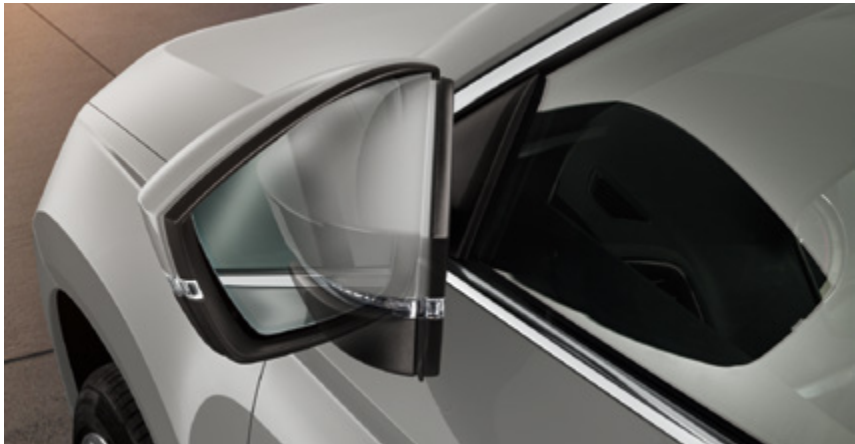
PREKLOPIVI RETROVIZORI Spoljašnji retrovizori imaju mogućnost automatskog preklapanja tokom zaključavanja vozila, kako bi se zaštitili od oštećenja.
