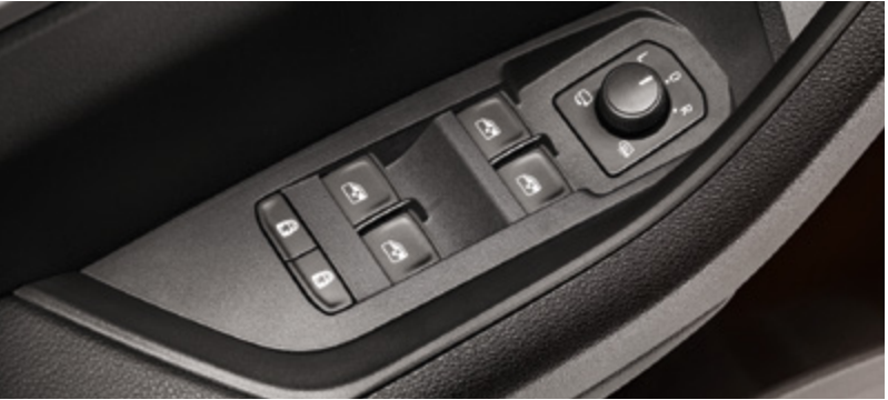
ELEKTRIČNO ZAKLJUČAVANJE ZADNJIH VRATA Dovoljan je samo jedan pritisak na dugme kako bi vaša deca putovala još sigurnije. Zaštita za decu onemogućuje da se otvore zadnji prozori i vrata.
