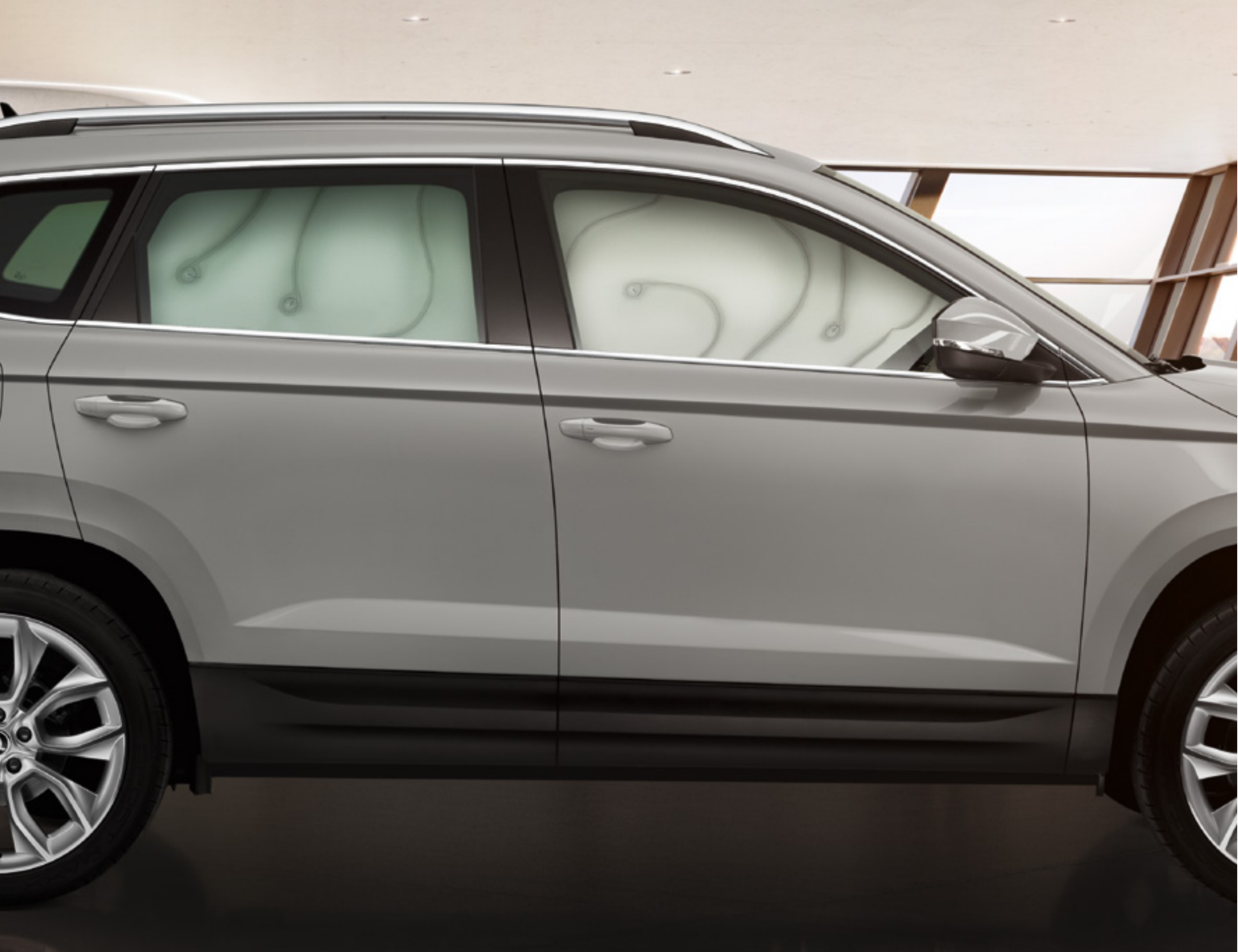
VAZDUŠNI JASTUCI ZA GLAVU Vazdušni jastuci za glavu tokom aktivacije prave pregradu i štite putnike na prednjim i zadnjim sedištima od povređivanja glave.
