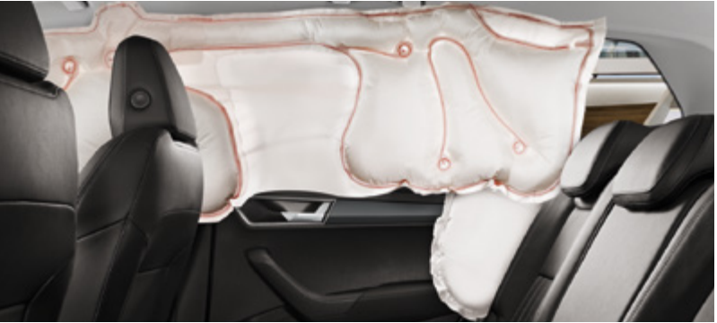
PREDNJI I ZADNJI BOČNI VAZDUŠNI JASTUCI Ova četiri vazdušna jastuka štite karlicu i grudni koš vozača i drugih putnika, čak i u slučaju bočnog sudara.
