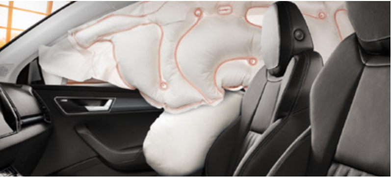
PREDNJI I ZADNJI BOČNI VAZDUŠNI JASTUCI Ova četiri vazdušna jastuka štite karlicu i grudni koš vozača i drugih putnika, čak i u slučaju bočnog sudara.
